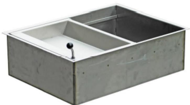
Ce passe-paquet coulissant en inox est une conception Loisirs Equipements, fabriqué en France. Il est équipé d'un caisson profond pour le passage de colis ou d'un terminal PIN-PAD et d'un tiroir coulissant pour le transfert de documents. Résistant, esthétique, équipé d'un balai d'étanchéité contre les courants d'air, il peut aussi être verrouillé côté agent.
